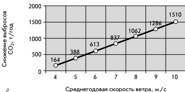
Рис. 4. Эффекты, достигаемые с использованием технологии совместной работы ТЭЦ и ВЭС при различных уровнях среднегодовой скорости ветра для ветроустановки мощностью 500 кВт:
